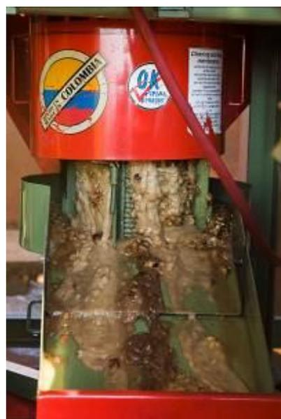
FIGURE 29: MUCILAGE OUTPUT FROM ECO-PULPER
