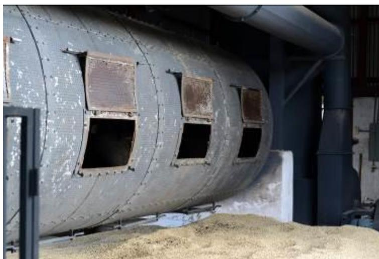
**FIGURE 43: MECHANICAL ROTARY DRYER**
