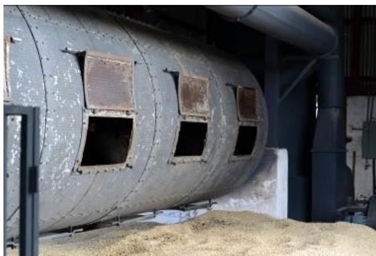
**FIGURE 43: MECHANICAL ROTARY DRYER**
